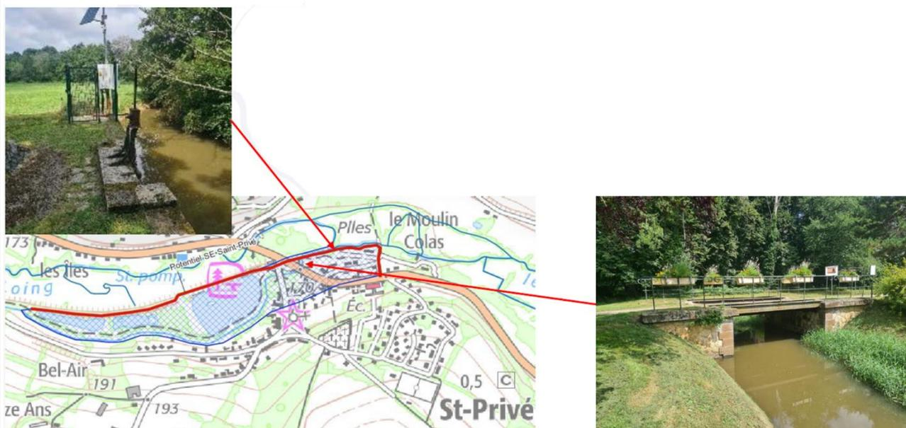
L'étude a permis de mettre en évidence une absence de surverse sur le remblai (en rouge sur l'illustration) jusqu'à Q100, hormis localement au droit de la vanne de prise d'eau de la rigole à partir de Q30 (cf. photo de
