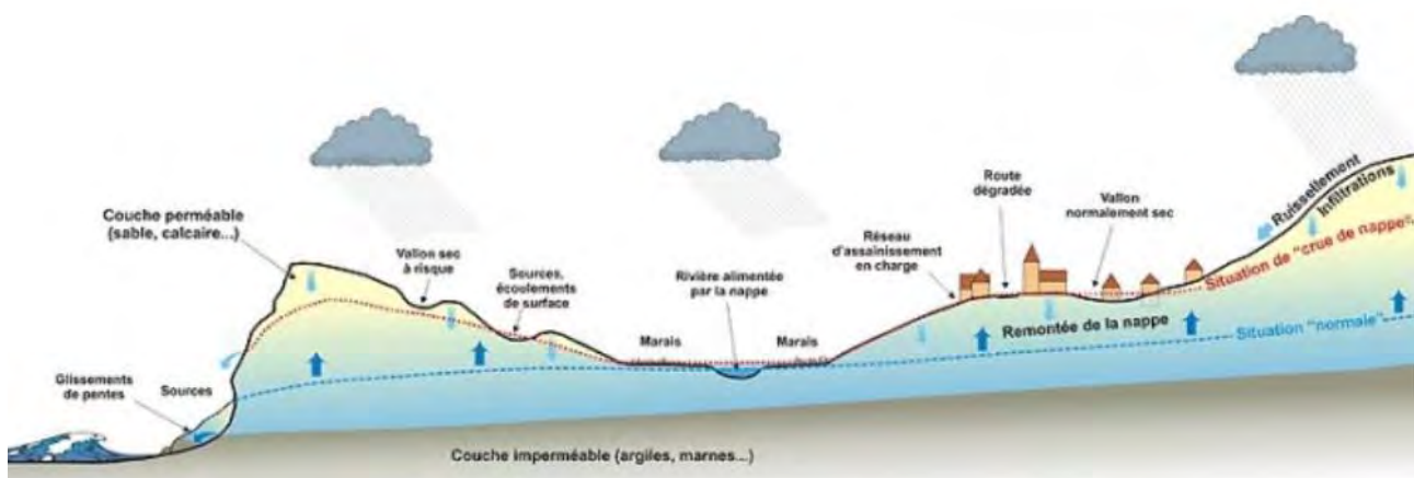
Figure 64 : Schéma explicatif d'une remontée de nappes. Source : BRGM, DREAL Basse-Normandie, 2020.
