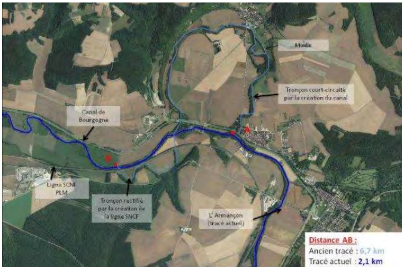
Figure 32 : Le Méandre de Saint-Martin-sur-Armançon (89) est une illustration de l'importante modification du tracé de l'Armançon suite à la création du canal de Bourgogne et de la ligne de TGV Paris-Lyon-Méditerranée. Source : SMBVA.
