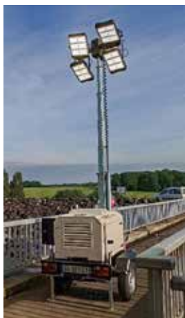
Mât d'éclairage déployé au cours de l'exercice
