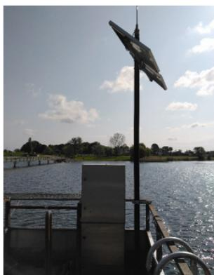
Installation d'une station de mesure de hauteur du bassin sud (Marne) autonome en énergie (panneau solaire)
