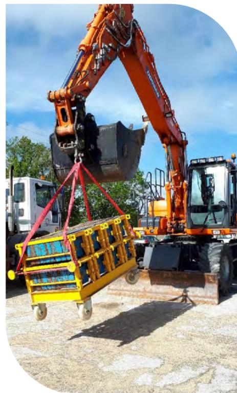
▲ ESSAI DE LEVAGE DANS LE CADRE D'UNE VÉRIFICATION PÉRIODIQUE
